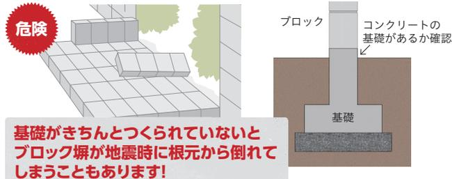
地面より上にあるブロックの最下段の下に、コンクリートの基礎があるかを確認してください。
