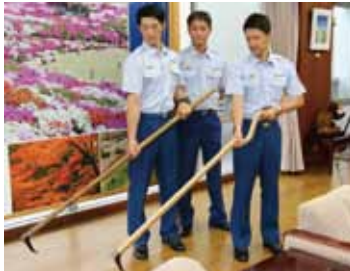
柄を波型に改良したとび口(写真手前)と柄が一直線の従来型のとび口。
